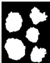
**Figura 5.2-1: Segmentación por umbrales de intensidad.** La imagen binaria de la derecha muestra la máscara resultante de aplicar un filtro de umbral a la imagen original (izquierda), con valores de intensidad entre 0 y 255. En la imagen máscara, cada píxel del fondo se identifica en por tener un valor de intensidad 0 (negro), mientras que los píxeles de las regiones segmentadas tienen un valor de intensidad 1 (blanco).
